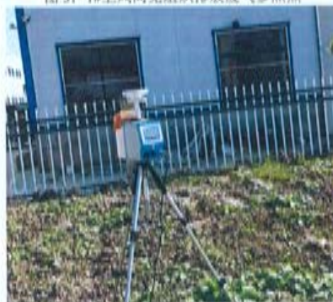
图 5: 3#下风向无组织排放废气监测点
